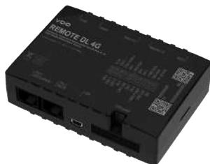
Izmantojot VDO "Remote DL 4G", jūs varat lejupielādētos datus caur GPRS pārsūtīt uz savas autoparka pārvaldības sistēmu vai analizēšanas programmatūru.
